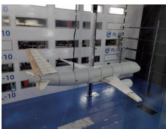
图 18 突风动载荷试验系统
