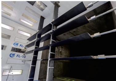
图8 突风发生器装置
