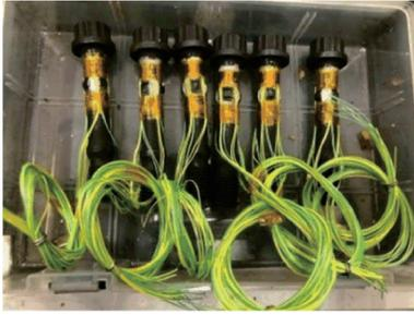
图 1 载荷测试螺栓
