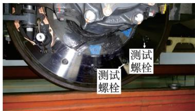
图 2 测试螺栓现场照片
