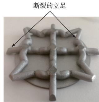
图 19 压溃的试件
