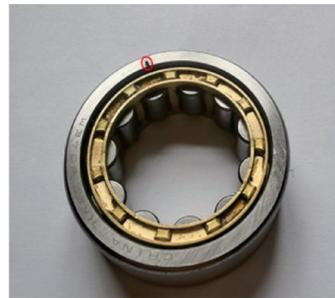
图 10 轴承外圈故障示意图
