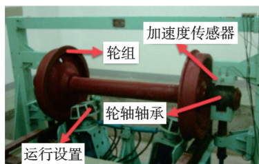
图 5 列车轮对轴承实验台
