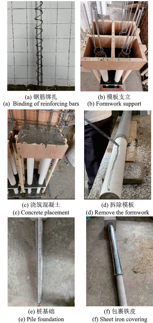
图3 模型桩的制作
