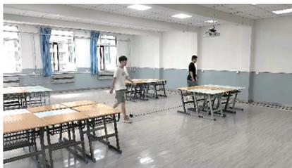
图 5 楼盖动力响应测试
