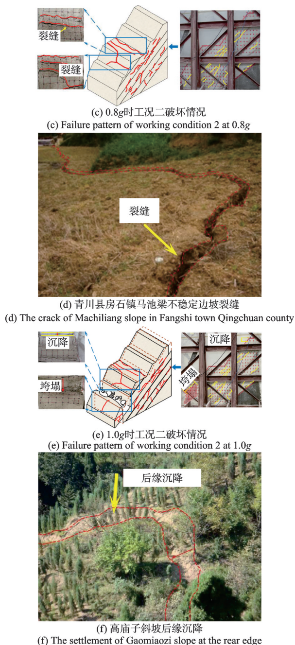
图10 试验中边坡模型破坏与实际发生破坏的对比
