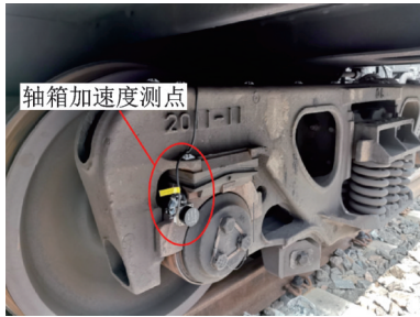
图 7 轴箱振动测试测点
